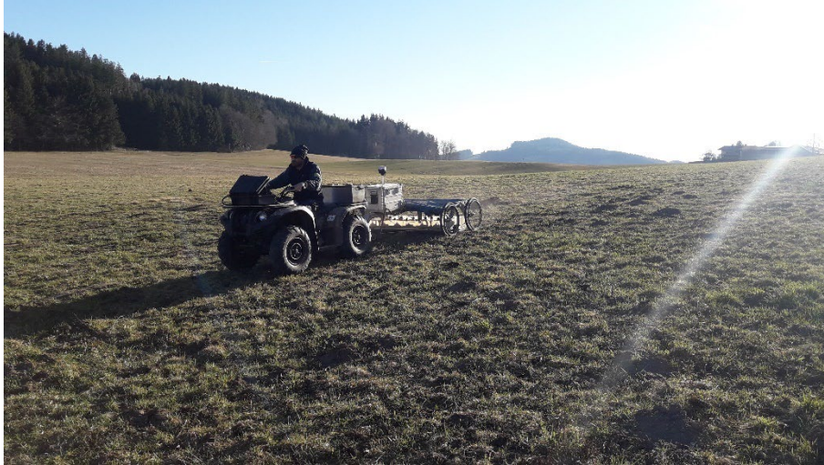
Das motorisierte Sensors & Software-Bodenradarmessgerät im März 2022 in Mattsee Schalkham im Einsatz. ZAMG (Archeo Prospections).
